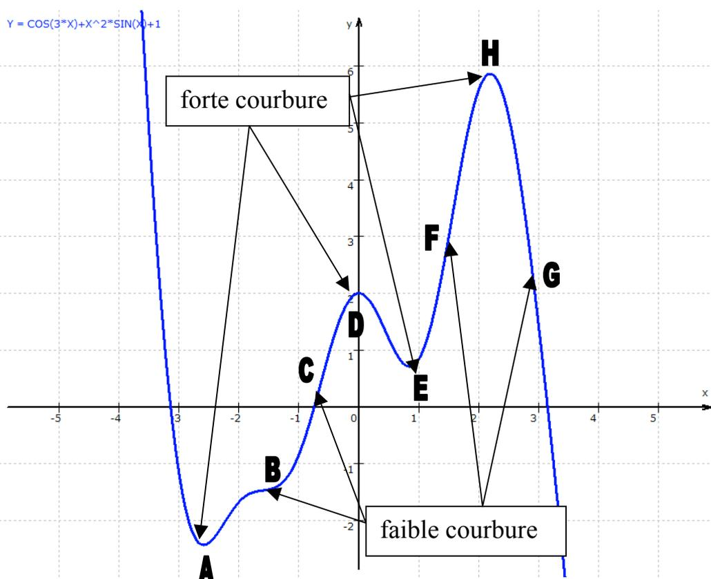
Imaginons une route dont le tracé aurait la forme de la courbe ci-dessus. L'automobiliste roulant sur cette route doit fortement braquer (manœuvrer le volant) aux points A, D, E et H, alors qu'il n'aura presque pas besoin de braquer aux points B, C, F et G. On dit que la courbe possède une forte « courbure » en A, D, E et H et une faible « courbure » en B, C, F et G.
